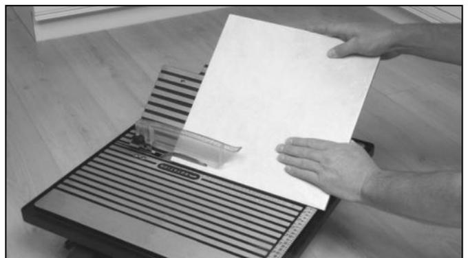
Starten Sie die Maschine. Schieben Sie die Fliese jetzt langsam gegen die Trennscheibe. Nachdem Sie den Schnitt gemacht haben, schalten Sie die Maschine aus.
