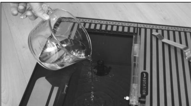
Vul het reservoir tot aan de overloop. Plaats nu het uitklapbare deel van de zaagtafel. Controleer het waterniveau regelmatig, dit om de diamantzaag niet droog te laten werken.
