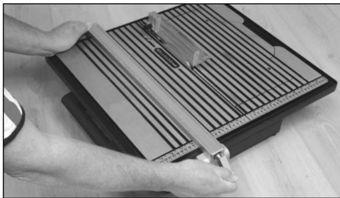
Placez la guide latérale sur le côté préféré de la table. Lorsqu'il est correctement aligné, le verrouiller en place en appuyant sur le réglage fermement vers le bas.
