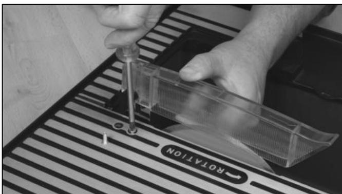
Fixez le protège-lame sur le support en utilisant le boulon et un écrou papillon.
