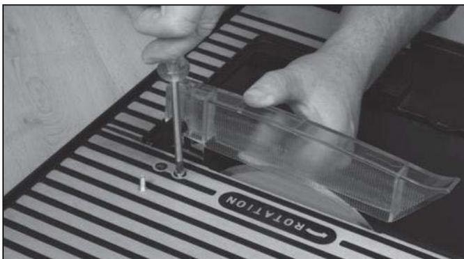
Innan du sätter tillbaka bordsskivan, fäst skyddsstödet i spåret bakom bladöppningen med de medföljande skruvarna. Fäst klingskyddet till stödet med hjälp av bult och vingmutter.
