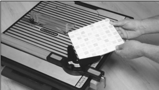
Draai de schroef weer aan en leg de tegel in de voorziene plaats van de variabele materiaalaanslag.
