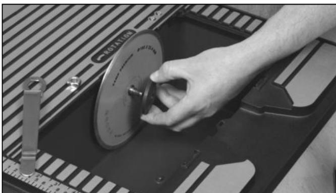
Pladser diamantklingen mod bagflangen. Vær sikker på at omdrejningsretningen, stemmer overens med maskinen. Monter flangen og møtrikken (Undgå at overspænde). Brug kun rene og hele flanger.
