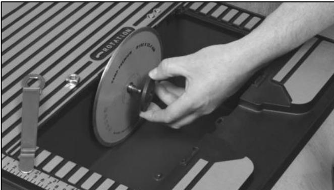
Plaats de diamantzaag op de achterflens en verzeker u ervan dat de draairichting van de zaag overeenstemt met de richting van de pijl op de zaagtafel. Monteer dan de voorflens en de moer. Span de moer niet te hard aan!
