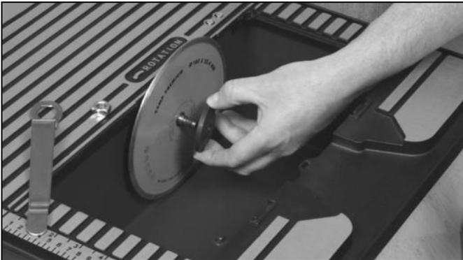
Setzen Sie die Trennscheibe auf dem hinteren Flansch und stellen Sie sicher, dass die Drehrichtung der Diamant-Trennscheibe mit der Richtung des Pfeils auf dem Schneidtisch übereinstimmt. Montieren Sie den vorderen Flansch und die Mutter. Ziehen Sie die Mutter nicht zu fest an.
