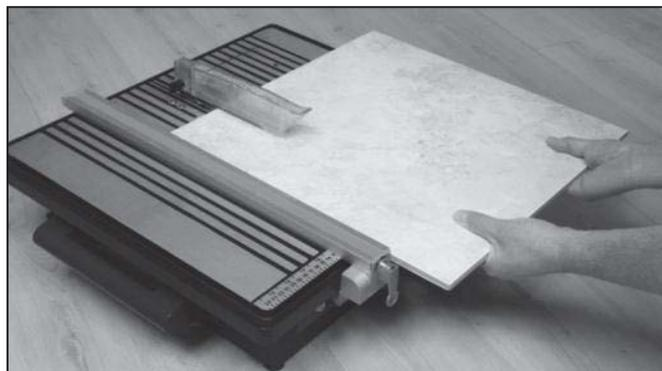
Hold et jevnt trykk, hold flisen mot kuttanholdet og dytt den støding gjennom kutteskiven. Når kuttet er ferdig, slå av maskinen.
