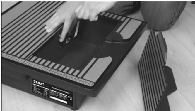
Pour installer ou remplacer le disque diamanté, d'abord prendre le côté amovible de la table de coupe. Enlever l'écrou et la flasque d'extérieur en utilisant la clé fournie.
