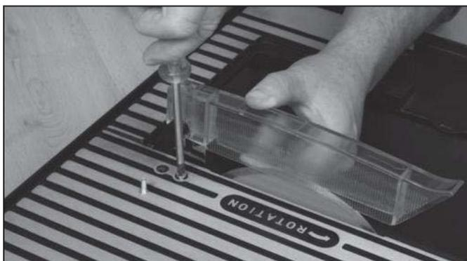
Før bordplaten settes på plass, fest beskytterstøtten i sporet bak bladåpningen med medfølgende skruer. Fest bladbeskytteren til støtten med bolt og vingemutter.
