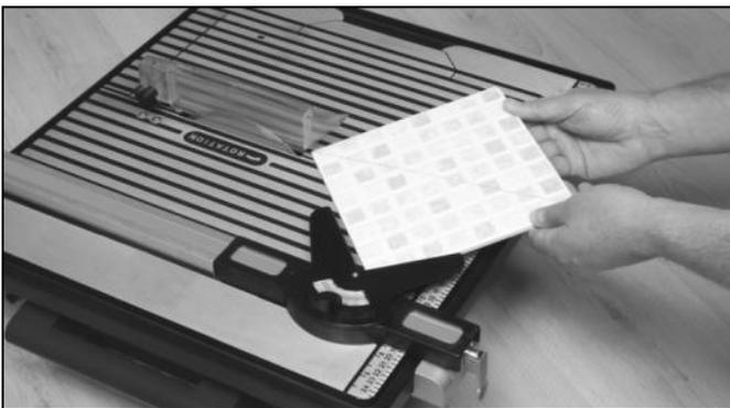
Befestigen Sie die Schraube und legen Sie die Fliese an den variablen Winkel-Anschlag.
