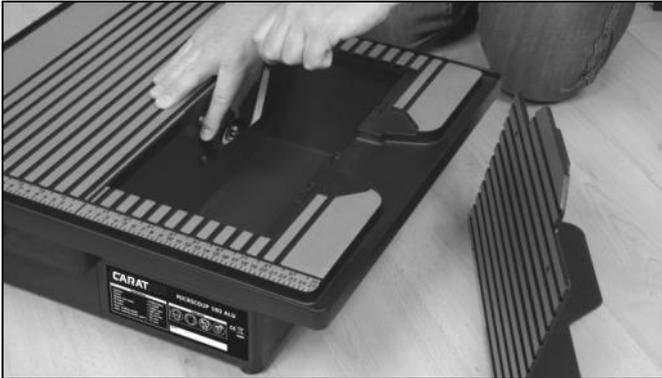
Om de diamantzaag te monteren of te vervangen, dien je eerst het uitklapbare deel van de tafel te verwijderen. Verwijder de moer en voorflens met de meegeleverde ringsleutel.
