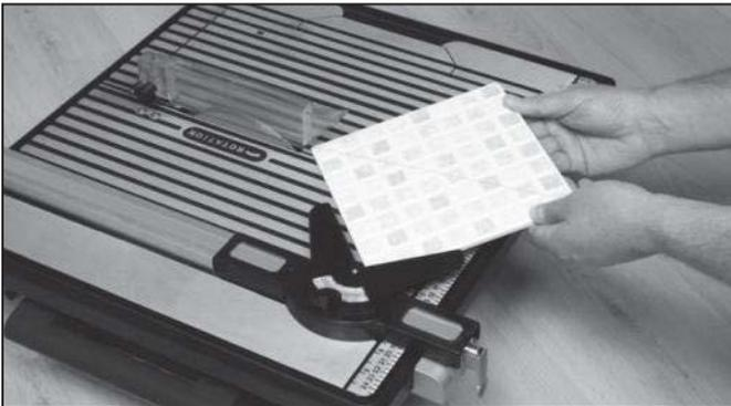
Stram knotten igjen og plasser flisen innenfor gapet på gjæringsstøtten.
