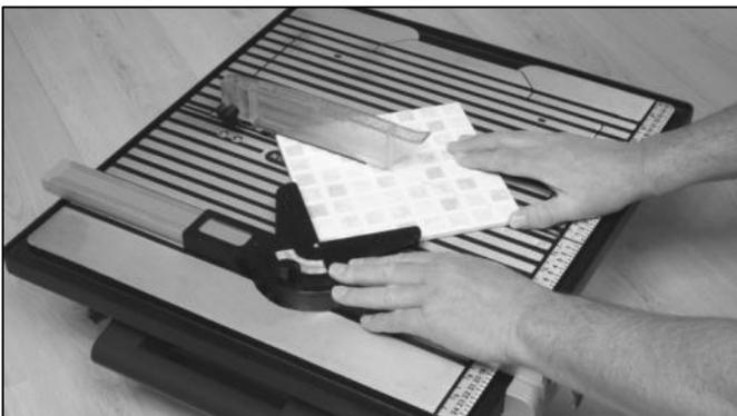
Schakel de machine in en duw de tegel tegen de diamantzaag. Als de zaagsnede gemaakt is, schakel de machine dan uit.
