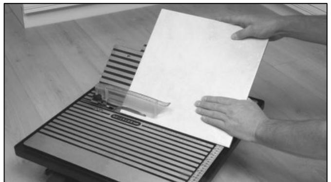
Schakel de machine in en duw de tegel rustig tegen de diamantzaag. Als de zaagsnede gemaakt is, schakel de machine dan uit.
