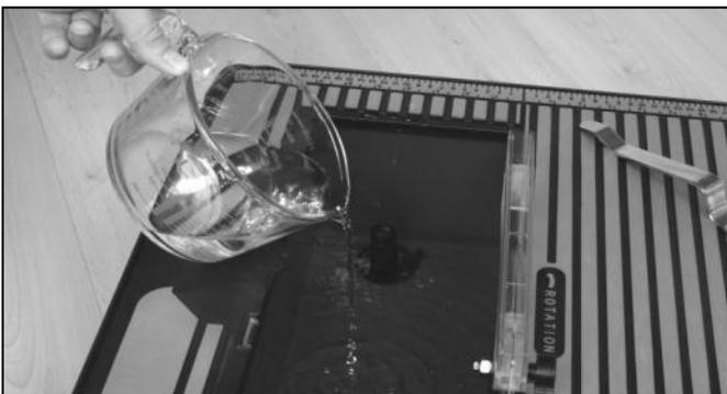
Füllen Sie den Behälter bis zum Überlauf. Setzen Sie nun den klappbaren Teil des Schneidtisches ein. Prüfen Sie den Wasserstand regelmäßig, so dass die Diamant-Trennscheibe nicht trocken benutzt wird.
