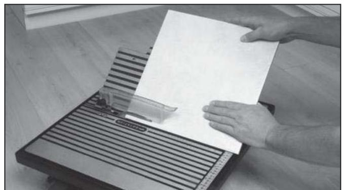
Slå på maskinen og mat flisen gjennom kuttskiven. Når kuttet er ferdig, slå av maskinen.
