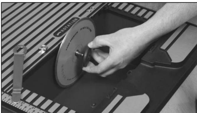
Placez le disque contre la flasque arrière assurant que la flèche directionnelle sur le disque correspond à celle sur la table de coupe. Remplacer la flasque avant et l'écrou.
