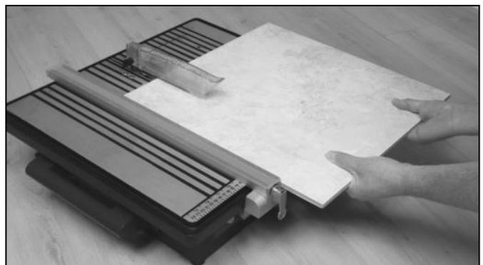
Schieben Sie die Fliese jetzt langsam gegen die Trennscheibe. Nachdem Sie den Schnitt gemacht haben, schalten Sie die Maschine aus.
