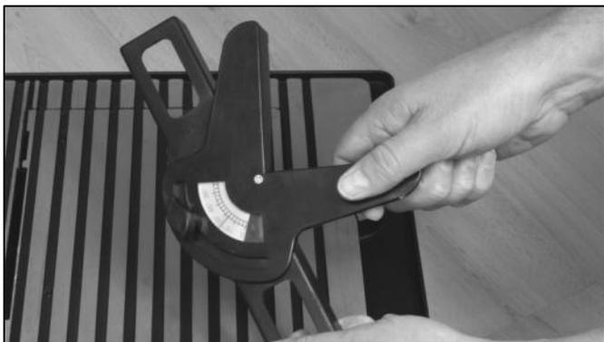
Faites glisser le guide à onglets en place sur le guide de bord.
