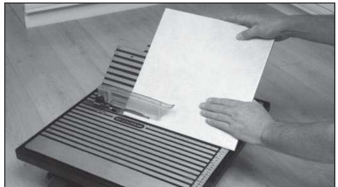
Slå på maskinen och mata plattan genom kaphjulet. När kapningen är klar, stäng av maskinen.
