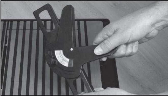
Skjv gjæringsstøtten på plass på parallellanholdet.
