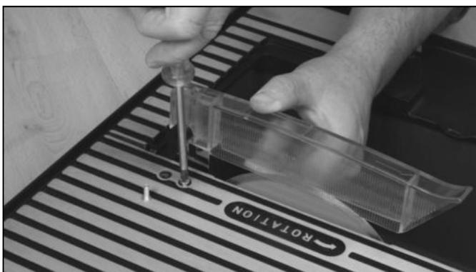
Før skærebordet monteres skal armen til klingebeskytteren spændes i sprækken med de medfølgende skruer, bag klingeåbningen. Monter herefter klingebeskytter på armen, med bolten og vingemøtrikken.
