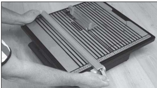
Placera klyvguiden på önskad sida av bordsskivan och i linje med linjalkanten till önskat mått för plattan som skall kapas. Vid korrekt inriktning, lås på plats genom att trycka justeringen stadigt nedåt.
