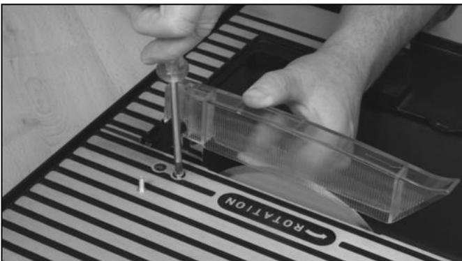
Montieren Sie den Halter des Blattschutzes. Montieren Sie jetzt den Blattschutz mit Hilfe von Flügelmutter und Bolzen.
