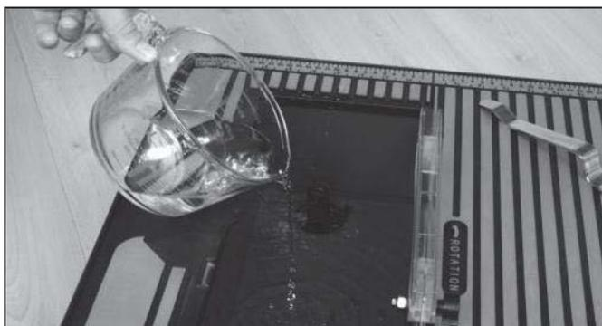
Fyll beholderen til et punkt like under overløpsåpningen ved toppen av avløpspluggen. Sett på plass kuttebordet. Gjør ofte kontroller under bruk – ikke la blade kjøre seg tørt.
