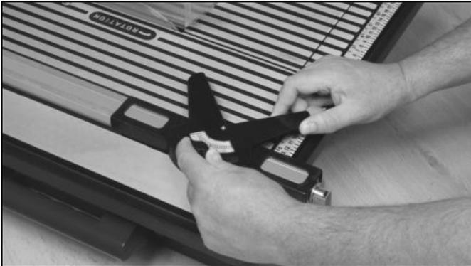
Draai de schroef los en stel de variabele materiaalaanslag in op de gewenste hoek.
