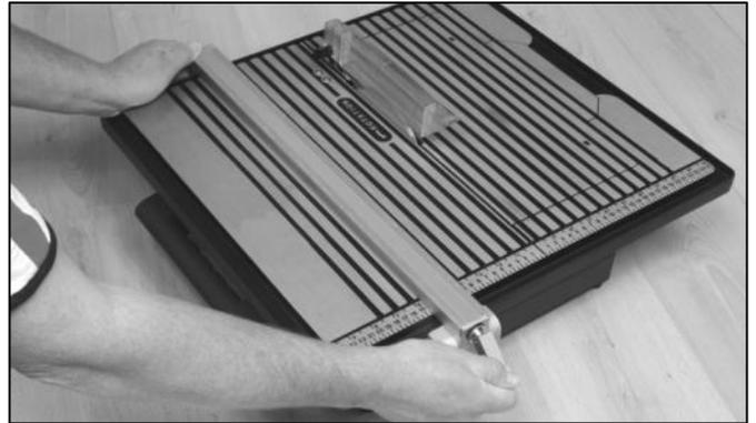
Plaats de rechte materiaalaanslag op de gewenste kant van de zaagtafel. Zorg er voor dat deze evenwijdig staat met de diamantzaag, de lijnen op de zaagtafel zorgen vergemakkelijken dit. Bij correcte uitlijning kan de materiaalslag vastgezet worden door middel van de snelspanklem.
