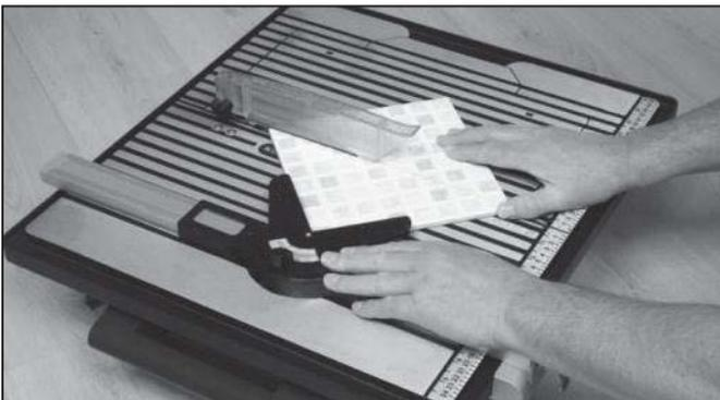
Slå på maskinen, og mens du holder flisen på plass med et fast grep, dytt gjæringsstøtten stadig langs parallellanholdet, slik at flisen mates gjennom kuttskiven. Når kuttet er ferdig, slå av maskinen.
