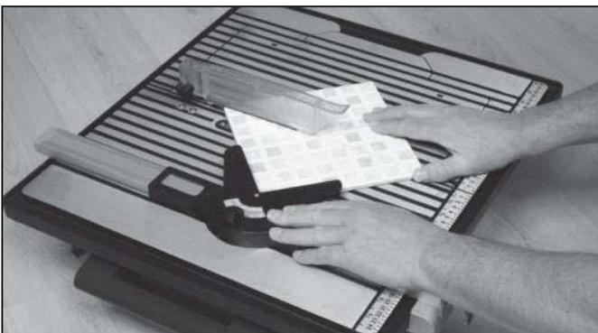
Slå på maskinen och samtidigt som du håller plattan stadigt på plats, tryck geringsguiden stadigt längs klyvguiden, mata plattan genom kaphjulet. När kapningen är klar, stäng av maskinen.
