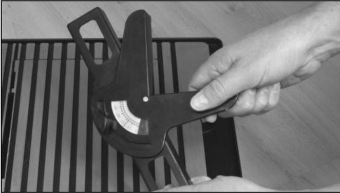
Schieben Sie den variablen Winkel-Anschlag auf der Geraden Material-Anschlag.
