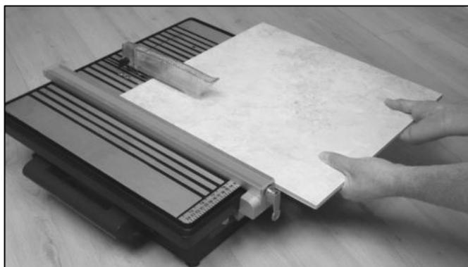
Maintenir une pression constante, maintenez le carreau contre le guide de coupe et pousser constamment dans le disque diamanté. Lorsque la coupe est terminée, éteignez la machine.
