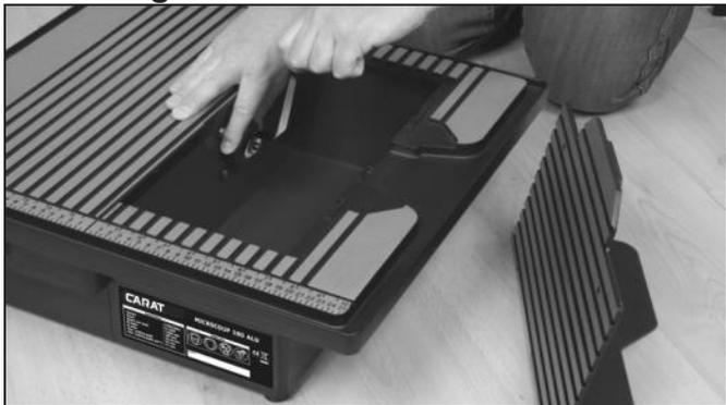
För att montera eller byta kaphjulet, ta först ut den löstagbara sidan av kapbordet. Ta bort muttern och brickan med hjälp av den medföljande skiftnyckeln.
