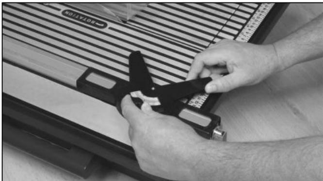
Desserrer la vis de serrage et régler l'angle de coupe désirée.
