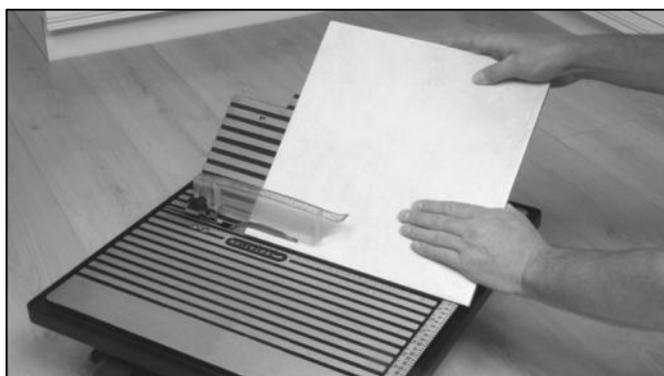
Démarrer la machine et poussez le carreau contre le disque diamanté. Lorsque la coupe est terminée, éteignez la machine.
