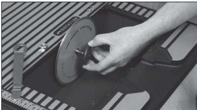
Still bladet mot den svarte kanten og sørg for at retningspilen på bladet stemmer med den på kuttebordet. Sett på plass kanten og mutteren på fremsiden. Ikke stram for hardt!
