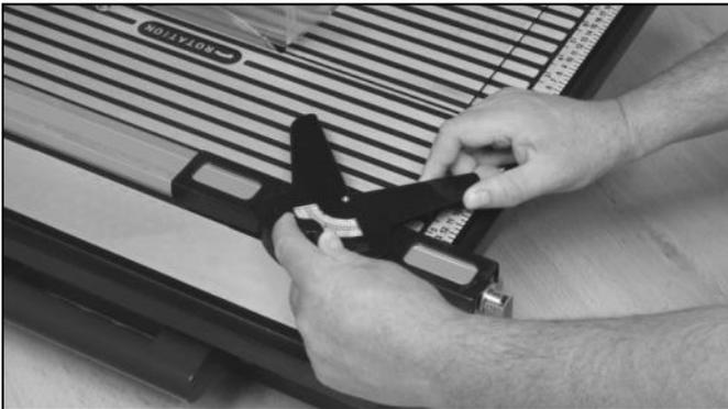
Lösen Sie die Schraube und stellen Sie den variablen Winkel-Anschlag auf den gewünschten Winkel.
