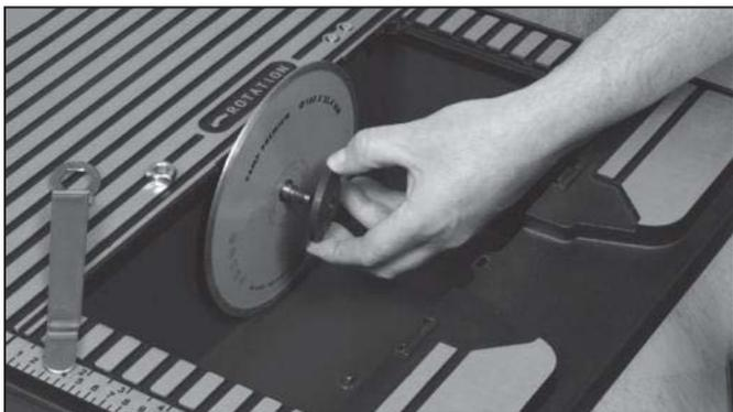
Placera bladet mot den bakre flänsen och säkerställ att riktningspilen på bladet överensstämmer med den på kapbordet. Sätt tillbaka den främre flänsen och muttern. Spänn inte för hårt!
