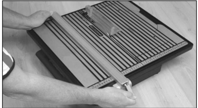
Stellen Sie den geraden Material-Anschlag auf die gewünschte Seite des Schneidtisches. Stellen Sie sicher, dass er parallel zu der Diamant-Trennscheibe ist, die Linien auf dem Schneidtisch machen dies leicht. Wenn der Materialanschlag richtig ausgerichtet ist, wird er mit Hilfe der Schnellspanner befestigt.
