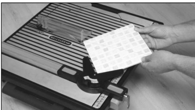
Resserrer le bouton et la position de la tuile dans les mâchoires du guide à onglets
