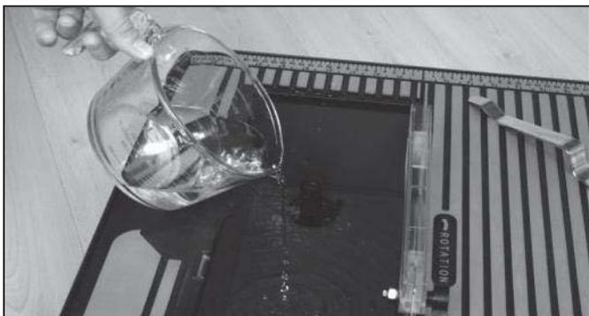
Fyll behållaren till en punkt strax under överströmningsöppningen vid toppen av avtappningspluggen. Sätt tillbaka kapbordet. Kontrollera vattennivån regelbundet under användning - låt inte bladet köras torrt.
