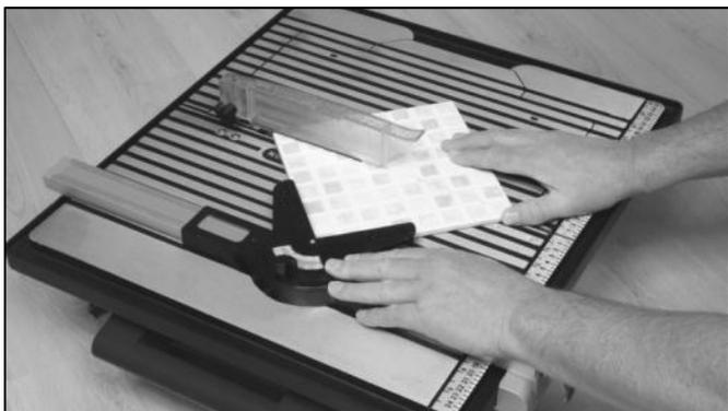
Allumer la machine, appuyer sur le guide à onglets de façon constante le long du guide latérale, poussant le carreau dans le disque de coupe. Lorsque la coupe est terminée, éteignez la machine.
