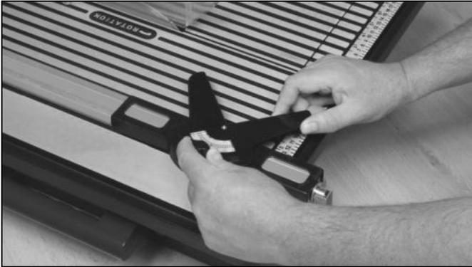
Fingerskruen løsnes, og justeres, til den korrekte vinkel.
