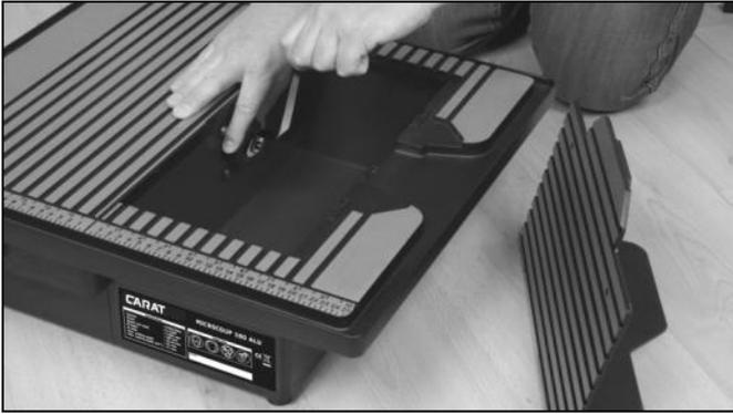
Um die Trennscheibe zu montieren oder zu ersetzen, müssen Sie den klappbaren Teil des Schneidtisches entfernen. Entfernen Sie die Mutter und den Flansch mit dem mitgelieferten Ringschlüssel.
