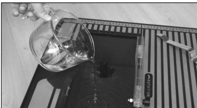
Remplir le réservoir à un point juste en dessous de l'ouverture de débordement dans le haut du bouchon de vidange. Vérifiez l'eau fréquemment pendant l'utilisation - ne permettent pas le disque de tourner à sec.
